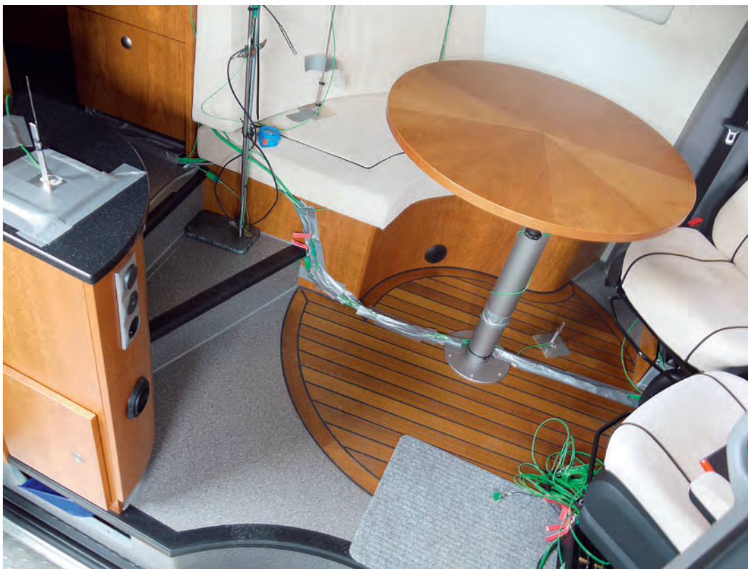
Verkabelt: Die Techniker von Webasto installierten im Kubus Meßfühler an allen interessanten Punkten im Fahrzeug (das Bett im Bild oben klappten die Techniker für die Messung nach unten).
