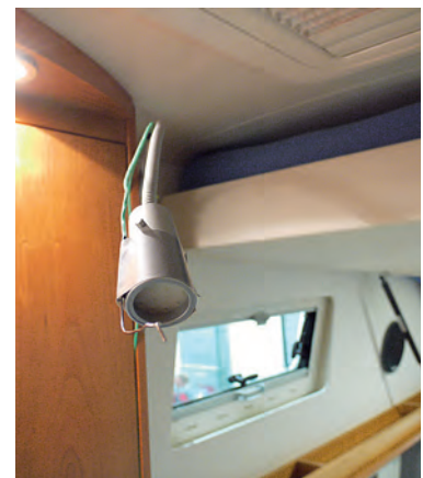
Verkabelt: Die Techniker von Webasto installierten im Kubus Meßfühler an allen interessanten Punkten im Fahrzeug (das Bett im Bild oben klappten die Techniker für die Messung nach unten).
